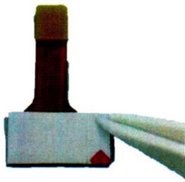
4. Аккуратно снимите пленку, закрывающую клеящий слой. Используйте специальный инструмент, не металлический.
