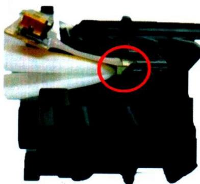
6. Надежно закрепите контактную плату чипа на корпусе.
